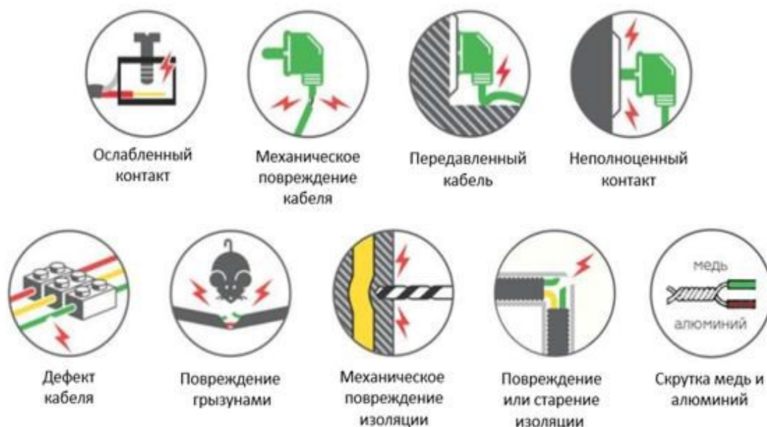
Рисунок 6. Возможные причины искрения в электропроводке
