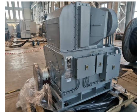
Гребной двигатель для привода мелкосидящего ледокола
